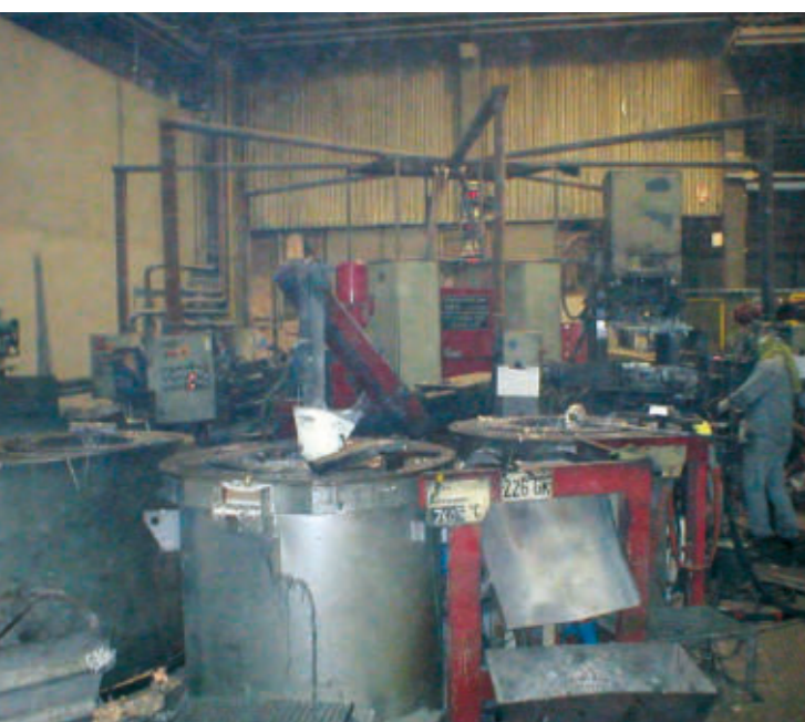
Gießkarussell mit acht Gießanlagen für den automatisierten Kokillenguss, 1984 installiert, Handtmann Metallgusswerk, Arthur-Handtmann-Straße, 2007
