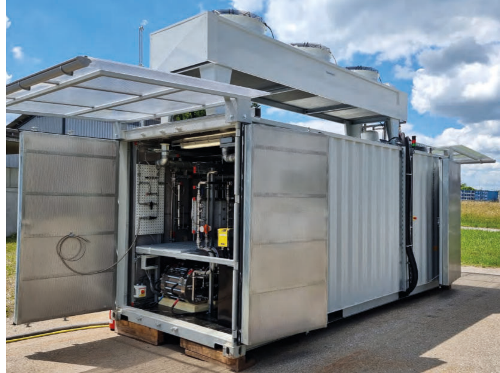
Elektrolyseur-Teststand: In Zusammenarbeit mit dem Fraunhofer Institut für Solare Energiesysteme (Freiburg) entwickelt die e-solutions einen modular aufgebauten Elektrolyseur zur Wasserstoffherzeugung, ein Beitrag zur dezentralen Energieversorgung, Handtmann e-solutions 2023
