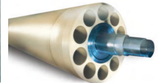
Siebzyylinder aus Lauramid® mit eingegossenem Ballenträger und axialen Entwässerungskanälen, L 310 cm, Durchmesser 58 cm, Handtmann Elteka, 1980er Jahre
