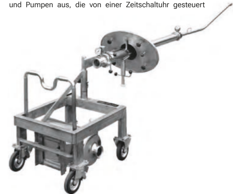
Handtmann-Reinigungslanze für Biertanks, mit einer Befestigungsvorrichtung an der ovalen Tanköffnung und der Sprühvorrichtung an einem bis zu sechs Meter ausfahrbaren Teleskoparm, Biberach 1972
