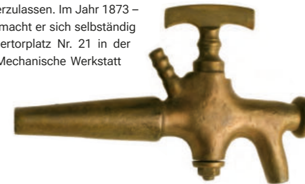
Fassanstich mit Kükenhahn, Messingguss der Firma Handtmann, 1920er – 30er Jahre, L 25 cm, links der Konus, der in das Fass eingeschlagen wird, rechts der Knauf, auf den der Hammer auftrifft. Diese Anstiche werden bei Handtmann seit 1873 hergestellt.
