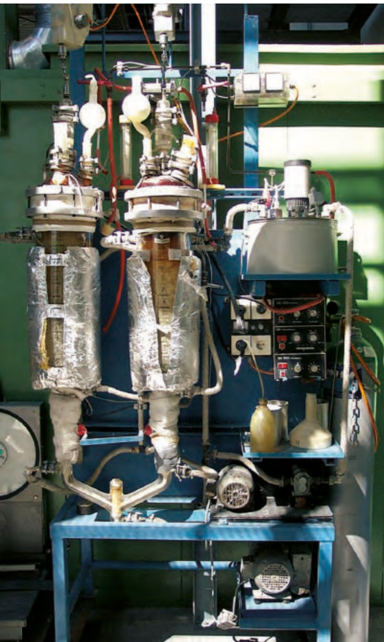
Glasanlage für die Herstellung der ersten Lauramid®-Kunststoffgussteile im Serienprozess, H 295 x B 170 x T 70 cm, Handtmann Elteka, Biberach 1976
