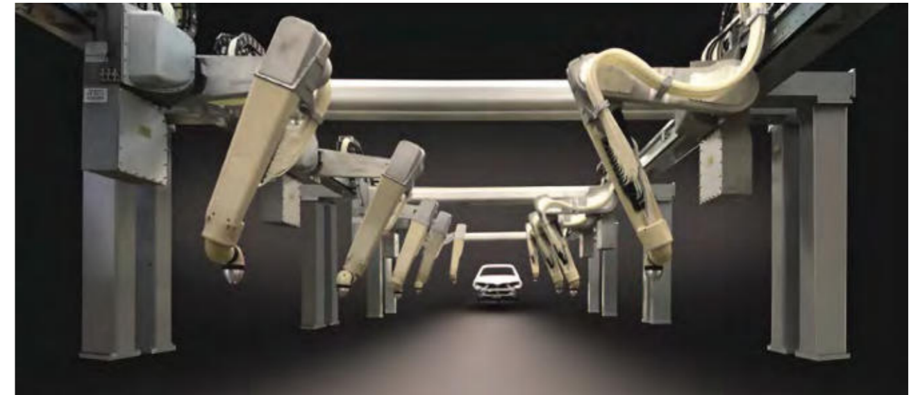
Roboterarme aus Lauramid® für automatisierte Lackierstraßen
