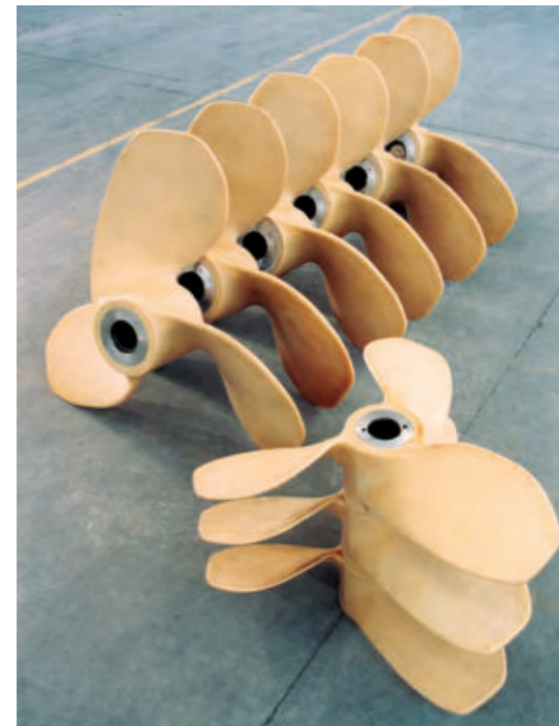
Büttenpropeller mit Edelstahlnabe, Kontur der Propellerblätter fertiggegossen, Flanschseiten mechanisch bearbeitet, 1980er Jahre
