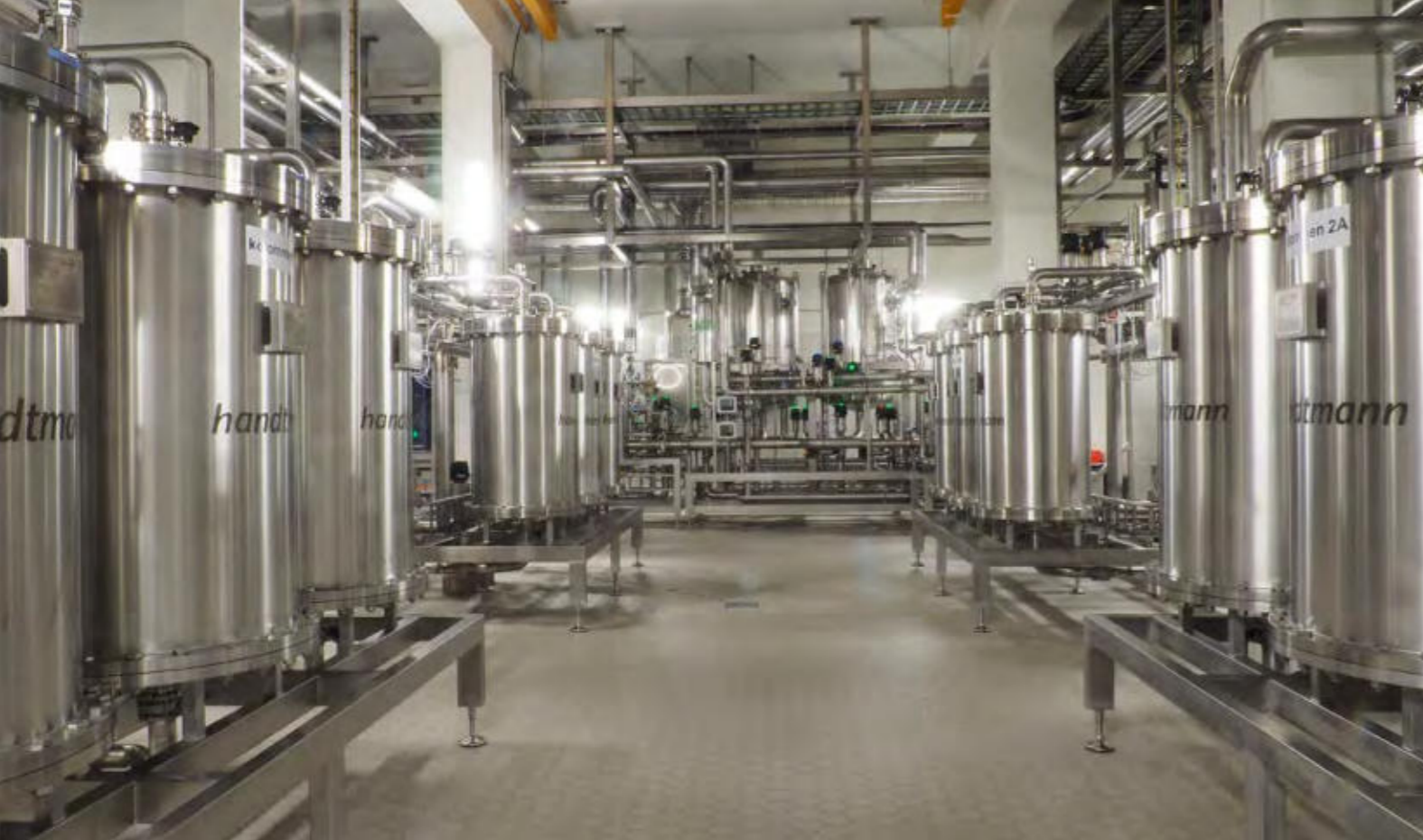
Großindustrielle Filtrationsanlage zur Gewinnung des Proteins Lactoferrin aus Kuhmilch, Handtmann Armaturenfabrik, Biberach 2023
