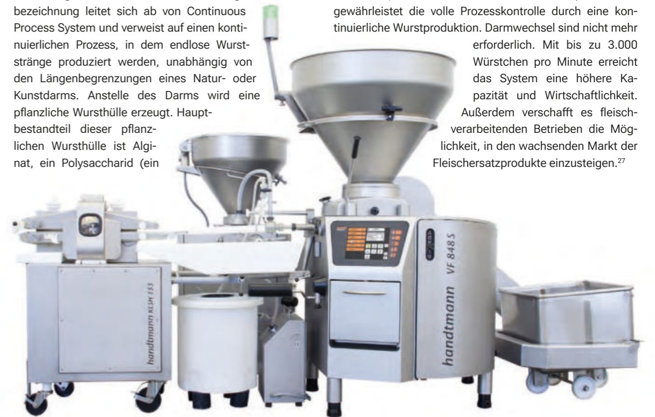
ConPro System zur kontinuierlichen Herstellung von Würstchen mit pflanzlicher Wursthülle, Handmann Maschinenfabrik, Biberach 2022
