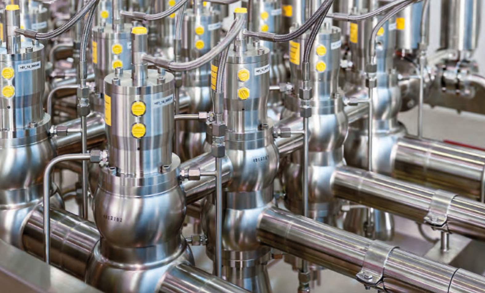
Ventilblock aus Doppelsitzventilen (Typ 491) zur gleichzeitigen Verteilung von Bier und Reinigungsflüssigkeiten, Handmann Armaturenfabrik, Biberach 2010
